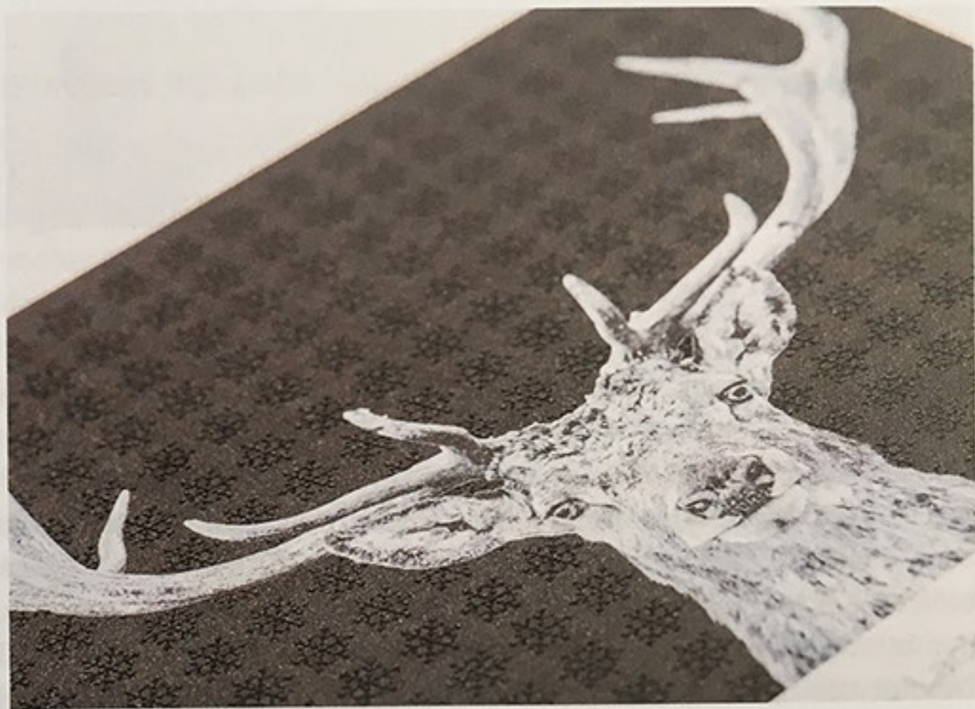
Deckweiss auf der HP Indigo 5600 und UV-Lackierung auf der Sodix S75.
