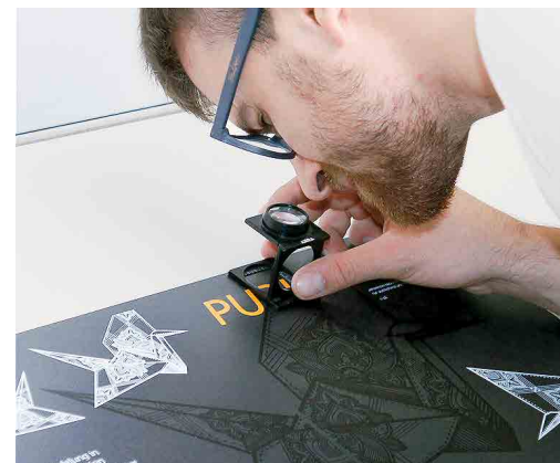
Passer-Kontrolle: Unter dem IndiChrome-Orange bez.-Grün ist Weiss gedruckt – für eine hohe Leuchtkraft auf dunklem Papier.
